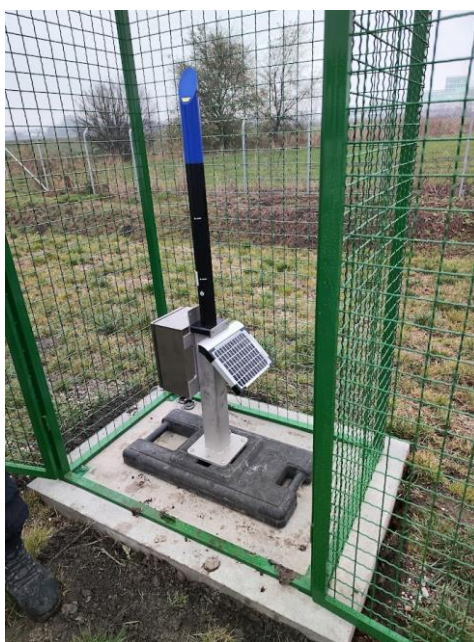
Слика 1.2: Детектор аутоматске станице за мерење јачине амбијенталног еквивалента дозе гама зрачења у ваздуху
