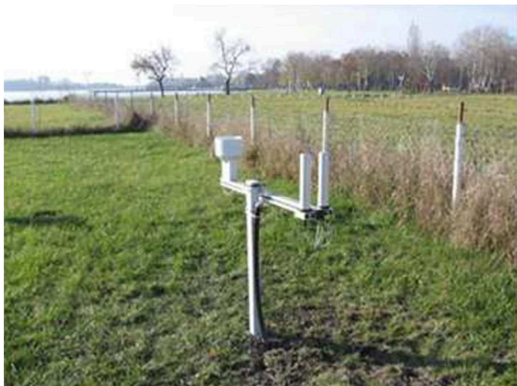
Слика 1.2. Детектор и кишни колектор аутоматске станице за мерење јачине амбијенталног еквивалента дозе гама зрачења у ваздуху
