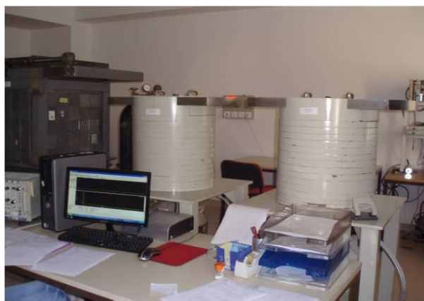
Слика 21. б) HPGe детектори у Лабораторији Заштита, Институт Винча
