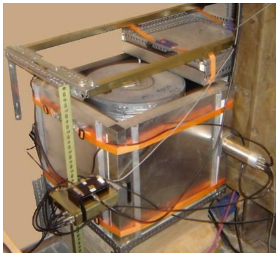
Слика 21. а) HPGe детектор GMX проширеног мерног опсега у пасивној и активној заштити, Нови Сад
