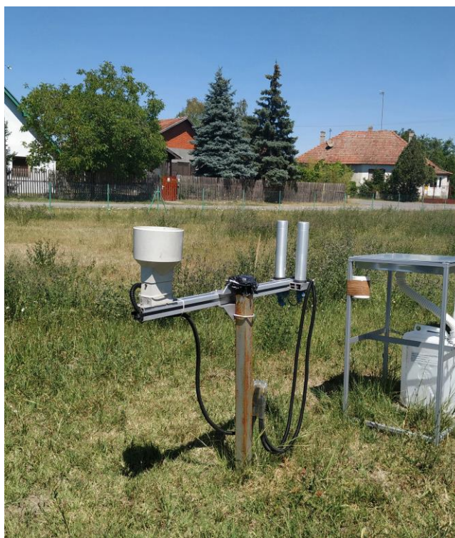
Слика 1.2: Детектор и кишни колектор аутоматске станице за мерење јачине амбијенталног еквивалента дозе гама зрачења у ваздуху
